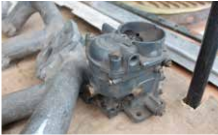
15six G karburator – og så var den endda revnet!
