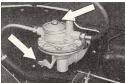
Benzinpumper: Øverst fabrikat S.E.V. og derunder en Guiot-pumpe. De to er brugt i flæng.
