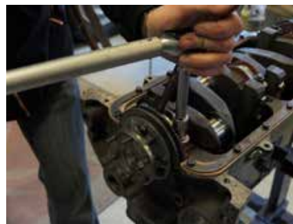
Efter tilspænding med momentnøglen låses alle 6 møtrikker med låseblækkene.
