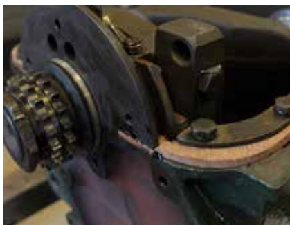
Efter sammenspænding kan man se at noget af korkpakningen pladrer ud – det skal skæres væk, så de ikke generer, når knastkædedækslets pakning lægges på. Se også foto nedenfor.
