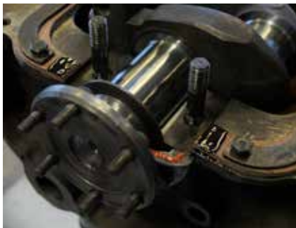
Harpiksbaseret til korkpakning – og siliconebaseret pakmasse til krumtappens olietætningsring, der i øvrigt normalt monteres bagefter.
