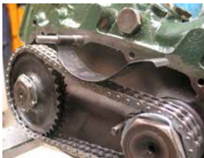
Kædestrammeren er ikke en original ting, men kan give flere fordele.
