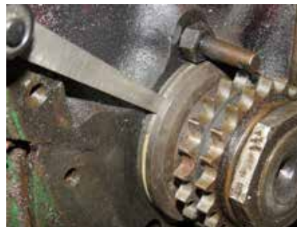
Måling af krumtappens endeslør med søgterblad.
