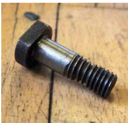
Advarsel: Prøv at se på denne svinghjulsbolt der har været overspændt, og derved er trukket ud over materialets flydegrænse – en sådan bolt må aldrig bruges!!
