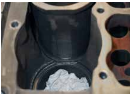
Første cylinder monteret. Bemærk de affasede dele af kanten, hvor foringerne vender mod hinanden.
