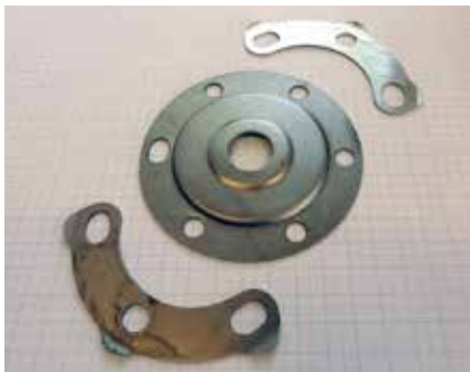
Låseblæk og dækplade til den gamle type. Brug altid nye låseblæk (overalt). De kan købes!
