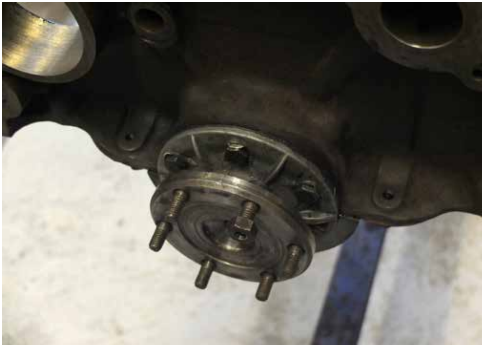
Låseblæk og dækplade til den gamle type. Brug altid nye låseblæk (overalt). De kan købes!
