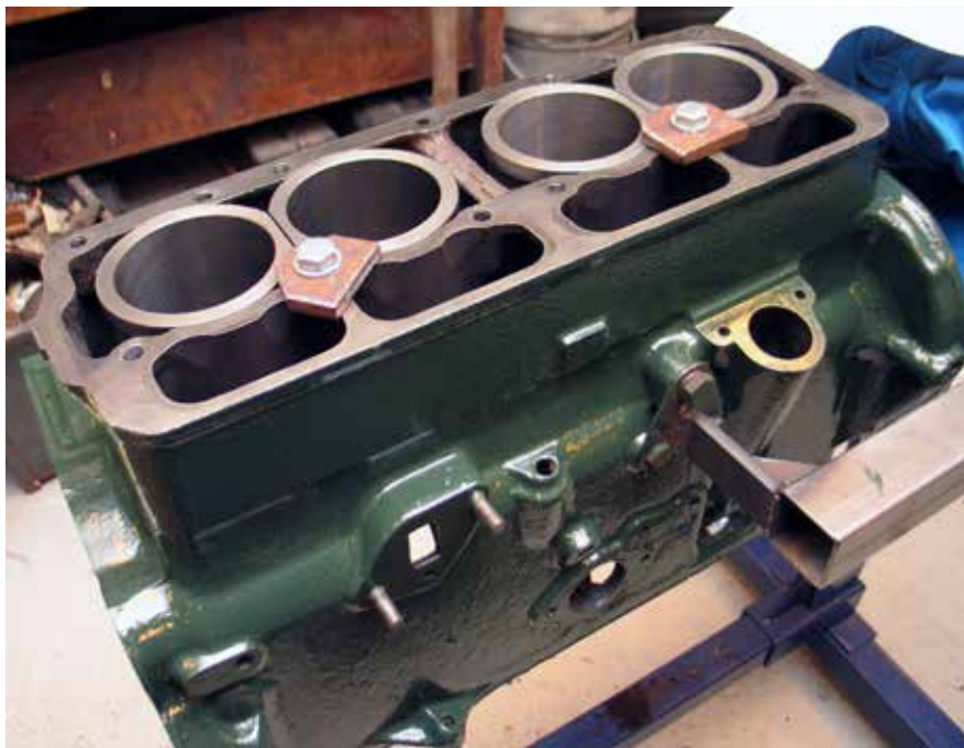
Efter montering af foringerne sikres de som her, så de ikke kan bevæge sig og ødelægge pakningerne. Skiverne/brikkerne er udformet så man kan komme til at montere stemplerne uden at løsne noget.
