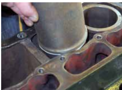
Efter kontrol af højden på alle 4 cylindre anbringes de i blokken med en smule flydende pakning på begge sider af papirpakningen. Papirpakningen skal sættes på foringen, og ikke lægges i blokken, ellers risikerer man at ødelægge den.
