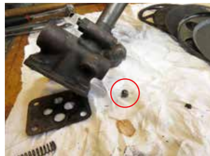
Kuglen (markeret med rød ring) og fjederen.
