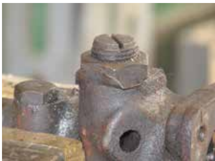
Justerskruen med kontramøtrik og låseblæk.
