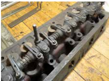
Topstykket med ventiler og vippetøj
