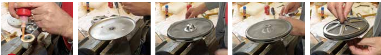
8 Filterets dækplade monteres med en pakning og resten af filterets dele samles med en bolt. Til sidst skrues kontramøtrikken på (se pil på billedet).
