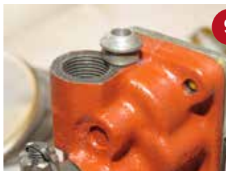
8 Filterets dækplade monteres med en pakning og resten af filterets dele samles med en bolt. Til sidst skrues kontramøtrikken på (se pil på billedet).
