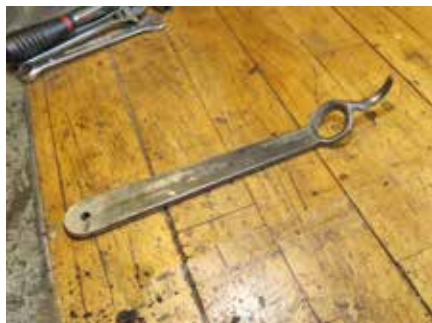
Værktøj til sammenpresning af ventilfjedrene
