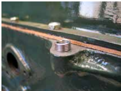
Gevindreparation med Helicoil.
