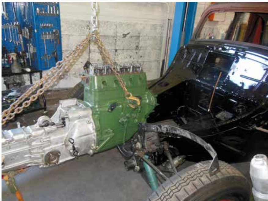
Ulf Stålnacke gennemrenoverede motoren i samarbejde med Lasse Törnblad. For- og bagtøj fik nye bøsninger og silentblokke. En god brugt gearkasse blev købt hos Peter Larsson. Differentialet havde lidt slør, men blev justeret af Bengt Möllerberg. Bedre hjælp er svær at finde.
