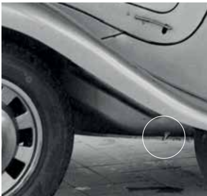
De små drænrør fra forrudeåbningen, som stikker ud under forskærmen blev opfundet fordi man manglede gummislanger (til motorrummet) under krigen! Det virkede. Der er vand på gulvet.
