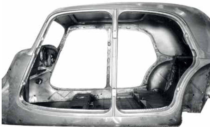
Her ses den nye udformning af vognbunden under bagsædet, og befæstningen af rørtraversen der er monteret fra bagsiden. De små "kasser", der dækker rørtraversens sværd er væk. Denne ændring blev foretaget på Normalerne allerede i 1939.
