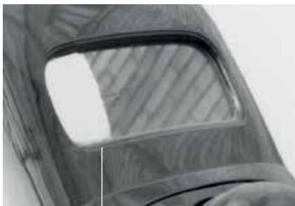
Bagrudens fals på et karrosseri fra før 1945. Sammenlign med billedet til venstre.
