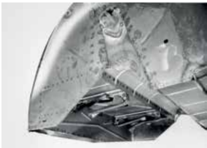
Øverst ses højre baginderskærm på en førkrigsbil, og derunder den noget mere enkle form fra 1945/46.
