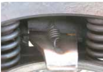
Eugenio måtte lade bilen stå - godset ved en koblingsfinger var knækket. En højst ualmindelig fejl! Søndag eftermiddag var bilen kørende igen, takket være en trykfod fra Leopold.
