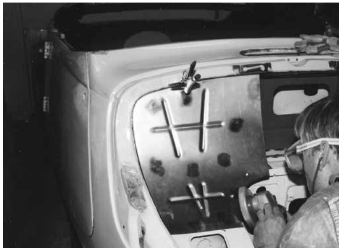
Af med det igen - og på med de omhyggeligt tilvirkede pladedele med de rigtige profiler. (Der er vist ikke så mange, der har set deres instrumentbrædt fra bagsiden!). På billedet nedenunder ses bilen ved ankomsten til Christiania, umiddelbart før lakeringen i juli 2005.
