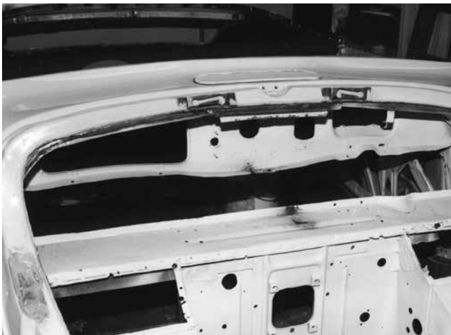
Af med det igen - og på med de omhyggeligt tilvirkede pladedele med de rigtige profiler. (Der er vist ikke så mange, der har set deres instrumentbrædt fra bagsiden!). På billedet nedenunder ses bilen ved ankomsten til Christiania, umiddelbart før lakeringen i juli 2005.
