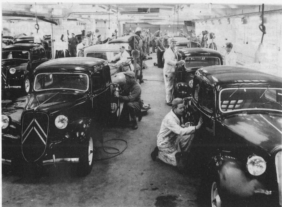
Vandslibning og efterpolering, i en tid hvor arbejdskraften kostede mindre end materialerne! 21 mand er i gang. Billedet er fra Sverige, året 1950 eller 1951.
