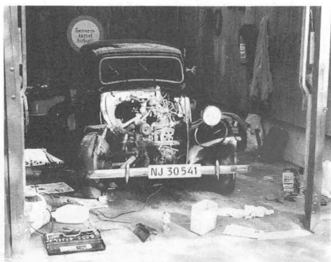
Egentlig var det kun det forreste vandpumpeleje der skulle udskiftes, men pludselig så vognen sådan ud.
