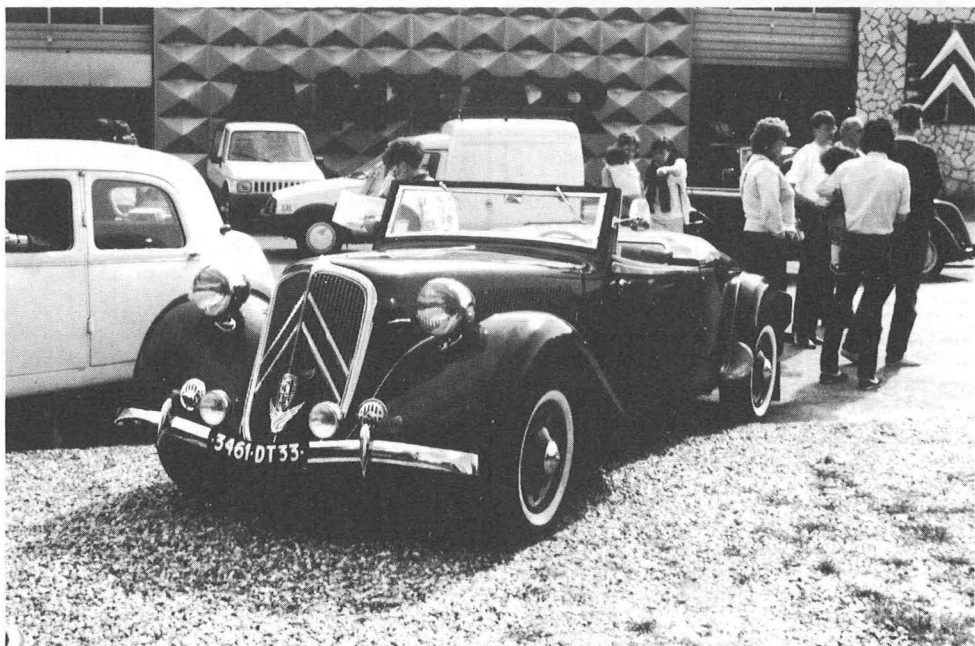
B15 Cabriolet restaureret som "optimal bastard" - bl.a. med skivebremser og hydraulisk styretøj a la DS! Jaja...
