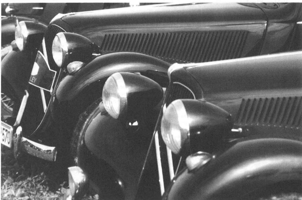
På TA-parkeringspladsen stod hundredevis af 11'ere. På dette billede ses en tydelig forskel mellem en Sport og en Normale: kølergitterets form i overkanten og deraf følgende forskel på beslaget der holder motorhjelmenes samleliste.
